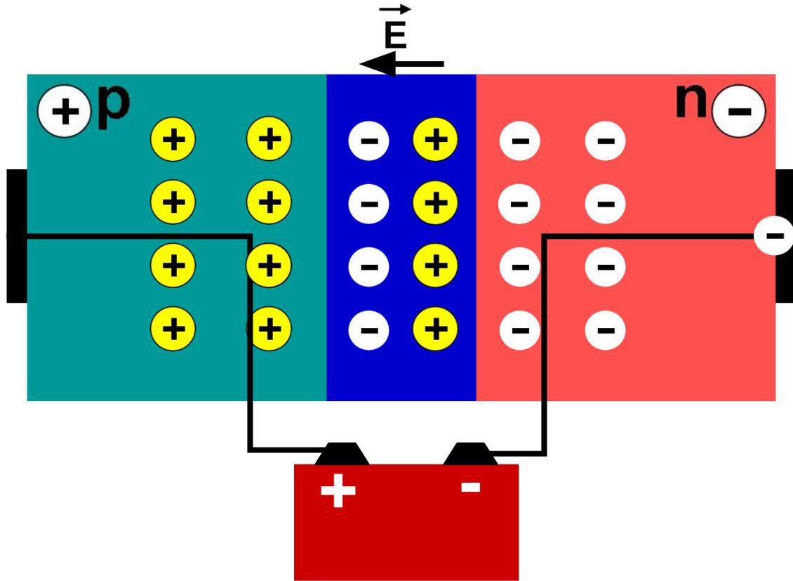
Способность  $p$ - $n$ -перехода пропускать ток практически только в одном направлении используется в приборах, которые называются полупроводниковыми диодами.
