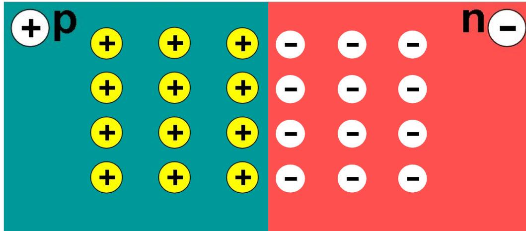
**Электрическая проводимость p-типа определяется дырками, поэтому их называют здесь основными носителями заряда, а электроны проводимости - не основными. В полупроводнике n-типа - наоборот.**
