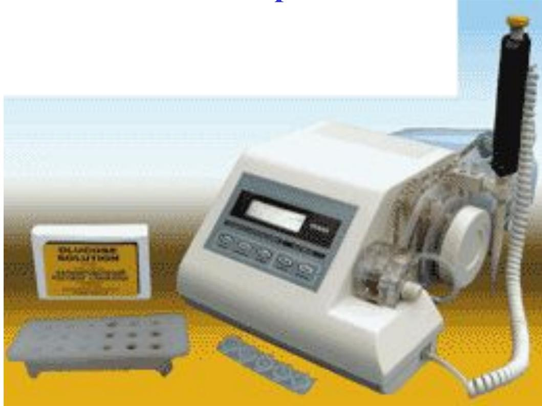
Автоматический цикл измерения и калибровки; контроль правильности забора пробы; автоматическое изменение длительности промывки, зависящей от концентрации глюкозы.
