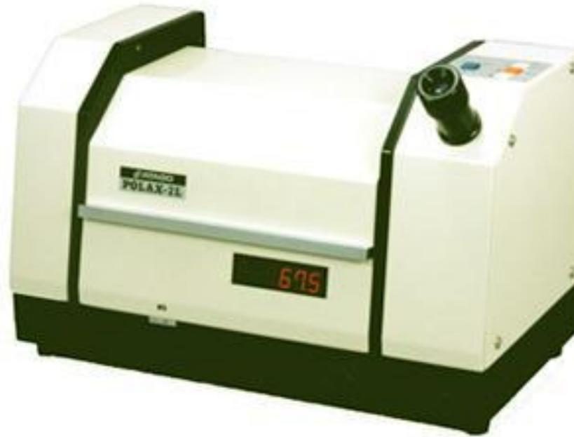
Поляриметр, известный как измеритель оптического вращения, является инструментом для измерения оптического вращения "оптически активных" веществ, таких как сахароза, аскорбиновая кислота и глутамат натрия.
