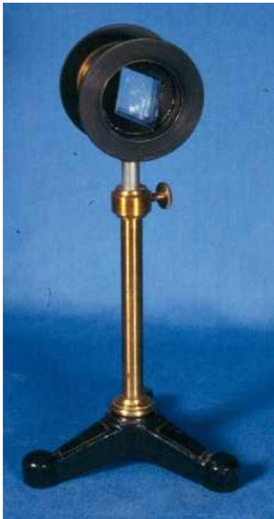
Поляризационное устройство, в основе принципа действия которого лежат эффекты двойного лучепреломления и полного внутреннего отражения. Устройство изобрёл Уильям Николь в 1820 г.
