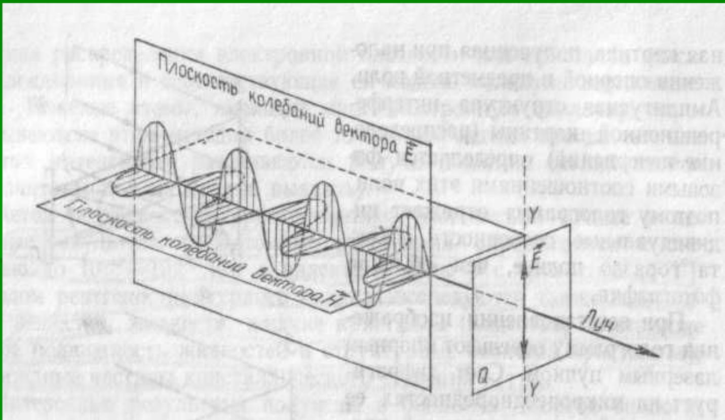
Поляризаторы способны пропускать только составляющую светового вектора  $E$ , лежащую в некоторой плоскости  $pp$ , называемой плоскостью поляризатора.
