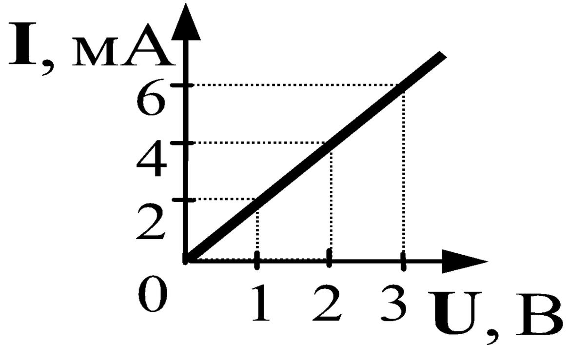
На рисунке изображен график зависимости силы тока в проводнике от напряжения на его концах. Чему равно сопротивление проводника?
