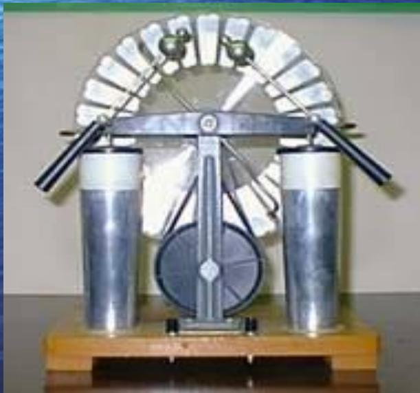
В источниках тока в процессе работы по разделению заряженных частиц происходит превращение механической работы в электрическую. Так например в электрофорной машине(см. рис.) в электрическую энергию превращается механическая энергия
