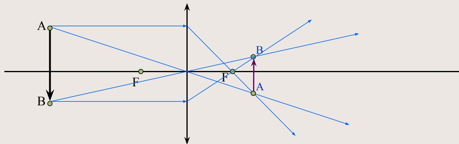
Проводим два «замечательных» луча из точки А и получаем её изображение
