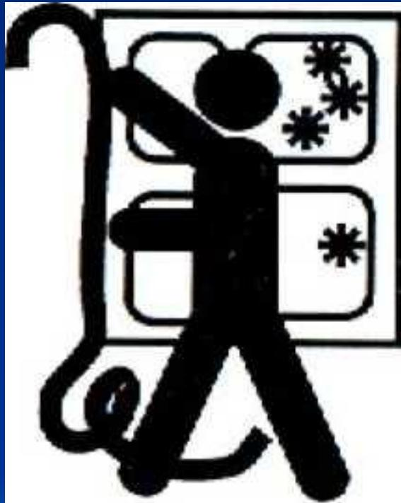
Утеплите дверные и оконные проёмы специальным уплотнителем, заклейте оконные рамы плотной бумагой или липкой лентой.
