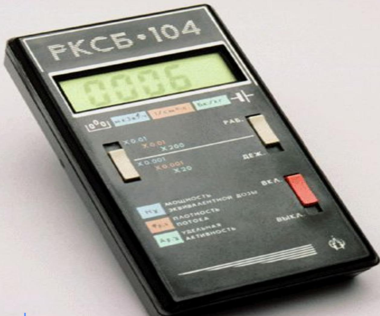
Он выполняет функции дозиметра и радиометра; обеспечивает возможность измерения удельной активности радионуклида Цезий – 137 в веществах.
