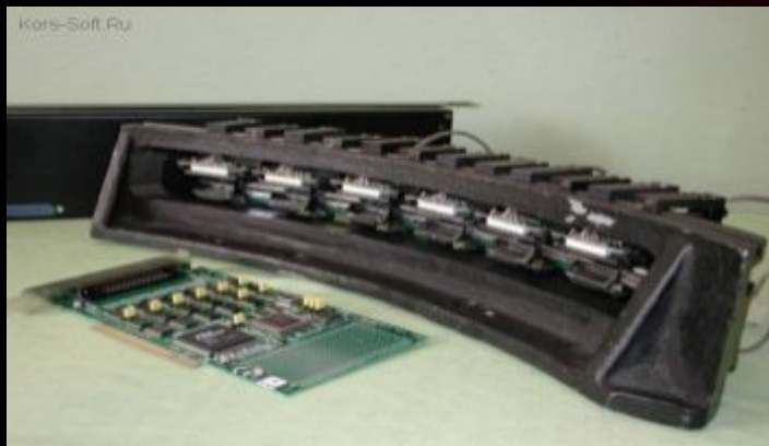
Эмиссионный спектрометр для анализа свинцовых и алюминиевых сплавов.
