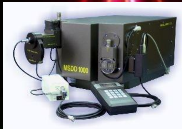
Монохроматор-Спектрограф с двойной дисперсией MSDD1000
