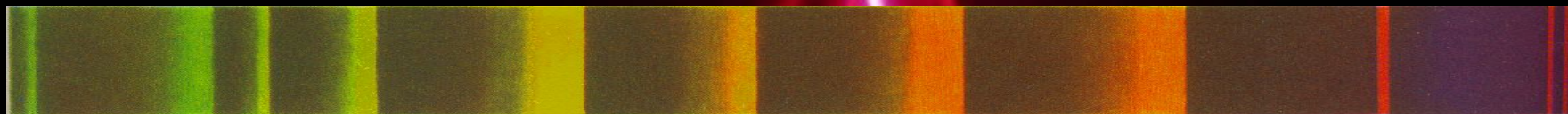
Спектр угольной дуги (полосы молекул CN и C 2 )
