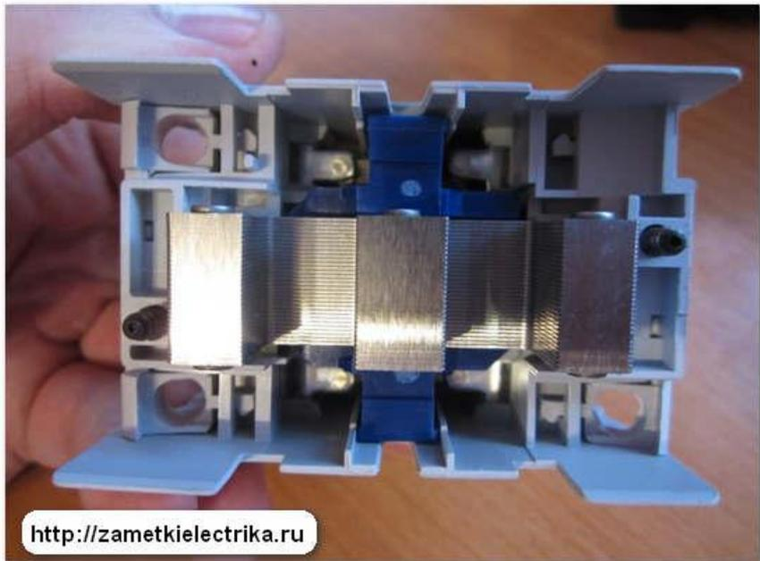
Чтобы добраться до контактной системы пускателя ПМЛ-1100, нам нужно снять нижние и верхние декоративные вставки. Смотрите последовательность на фотографиях ниже.
