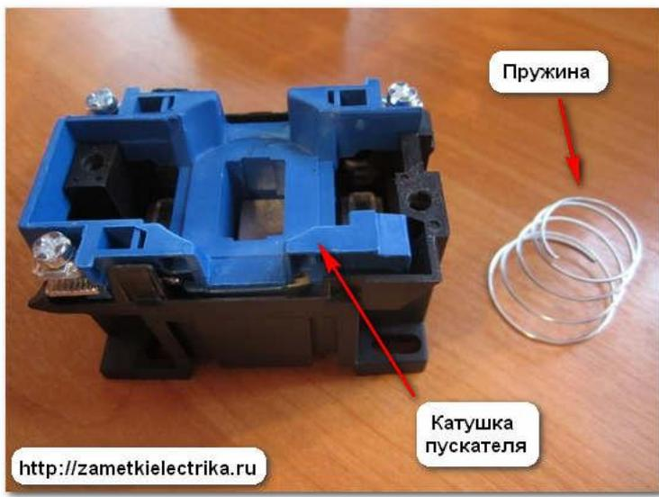
В одной половине корпуса установлена катушка с неподвижной частью сердечника (магнитопровода).
