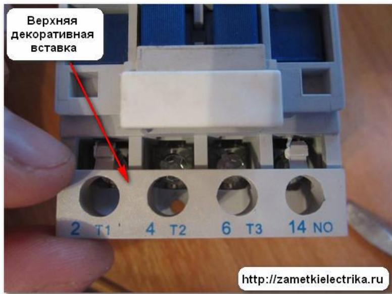
А теперь вытащим неподвижные контакты из направляющих пазов пускателя. Я это делаю с помощью
