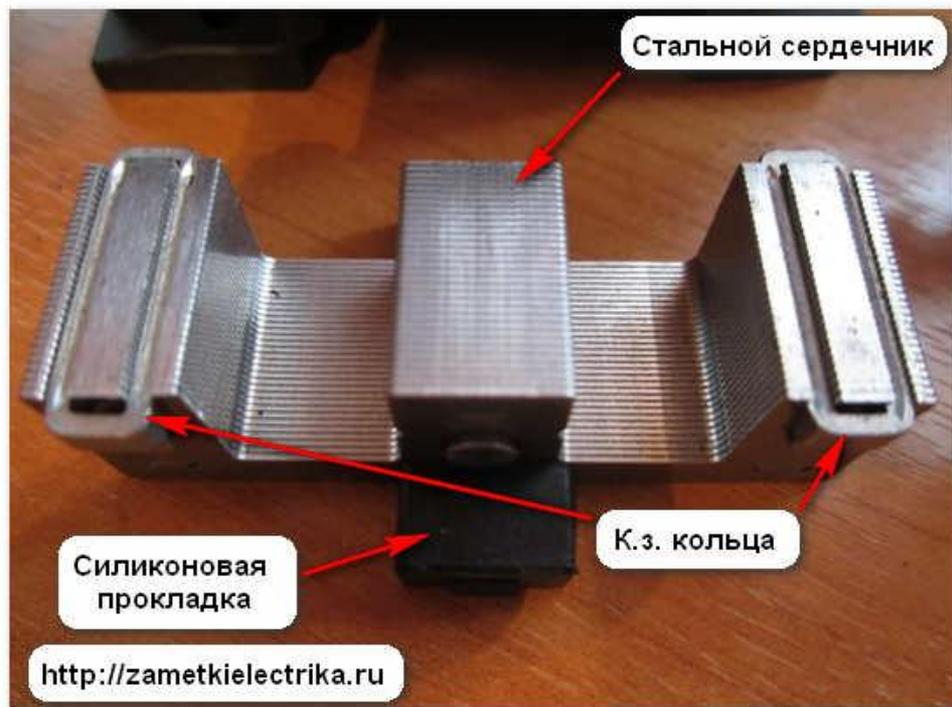
Место соединения подвижной и неподвижной части сердечников имеет шлифованную и гладкую поверхность. Там же установлены два короткозамкнутых кольца для уменьшения вибраций при включении пускателя. Если эта поверхность загрязнится каким-либо образом, то пускатель во включенном положении будет сильно гудеть. Обо всех неисправностях пускателей и контакторов я расскажу Вам в следующих своих статьях.
