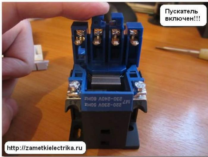
При снятии переменного напряжения 220 (В) с катушки пускателя, возвратная (противодействующая) пружина отталкивает подвижную часть сердечника в исходное состояние, тем самым размыкая силовые (главные) и вспомогательные контакты.
