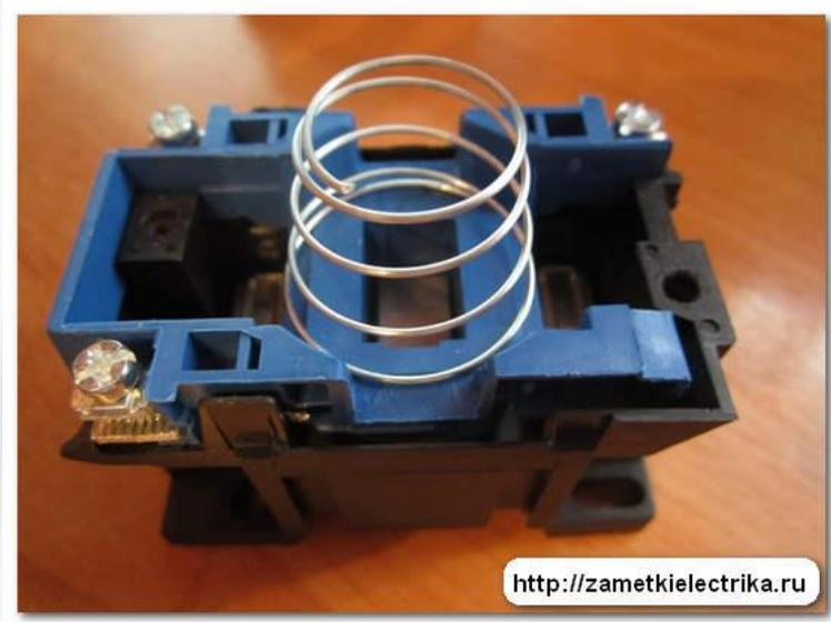
Возвратная пружина, ее еще называют противодействующей, расположена в центре катушки и возвращает контакты пускателя в исходное положение при отключении катушки пускателя от питающего переменного напряжения.
