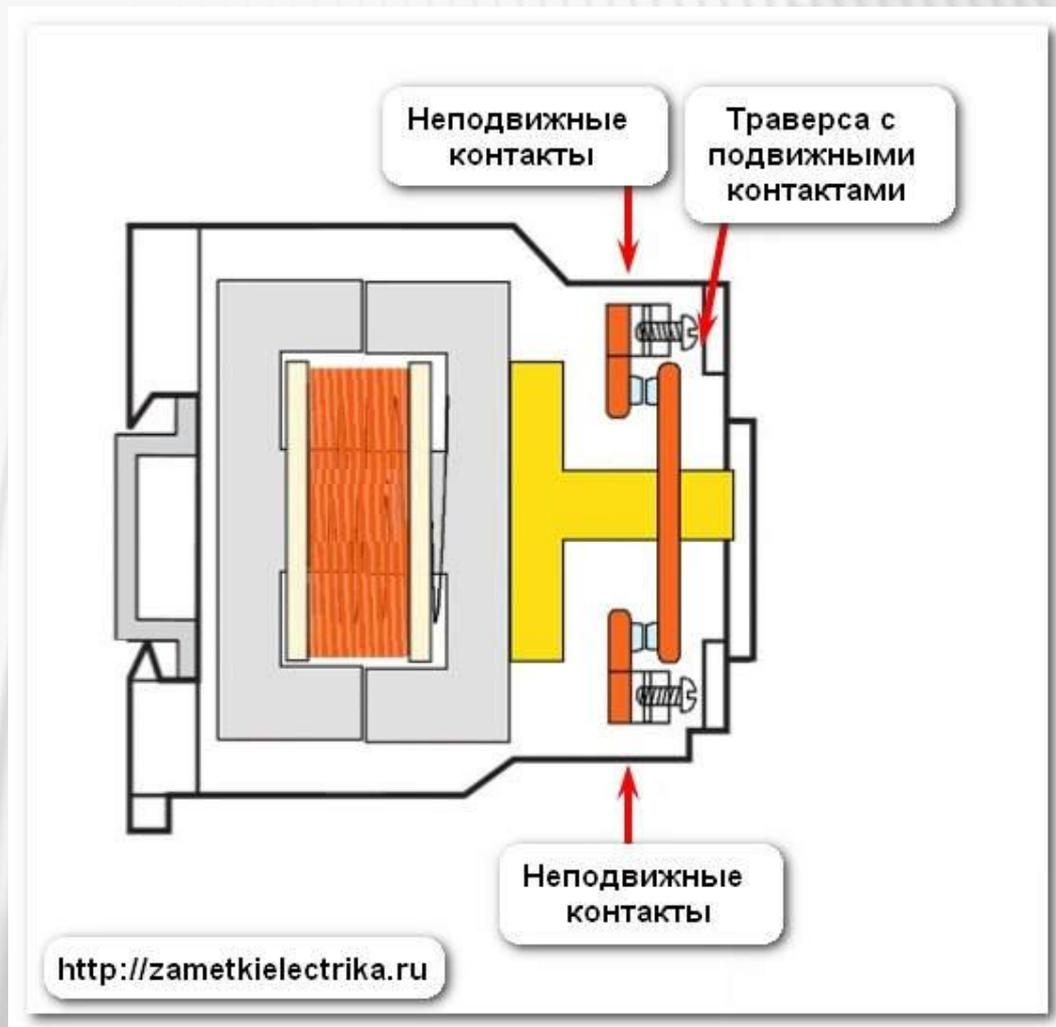
А вот наглядная имитация включенного магнитного пускателя ПМЛ-1100 без корпуса.
