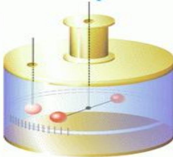
Закон Кулона был экспериментально установлен с помощью крутильных весов
