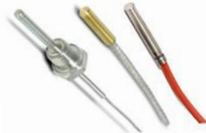
Принцип действия таких датчиков основан на изменении их электрического сопротивления от температуры объекта. В общем виде зависимость имеет вид  $R_t = R_0(1 + \alpha t)$ , где  $R_t$  — сопротивление датчика при его нагревании на  $t$  °С;  $R_0$  — сопротивление датчика при 0 °С;  $\alpha$  — температурный коэффициент.
