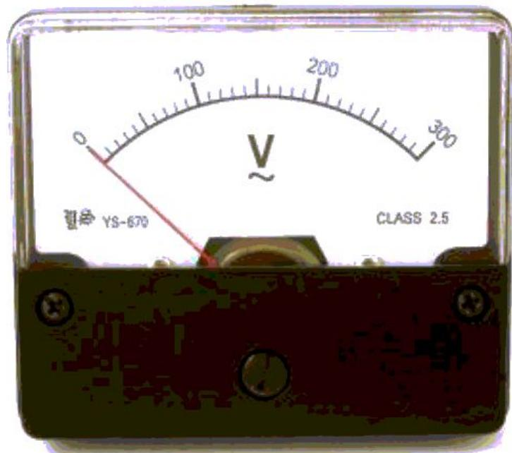
**Вольтметр** – прибор для измерения напряжения на участке электрической цепи. Для уменьшения влияния включенного вольтметра на режим цепи он должен обладать большим входным сопротивлением.
