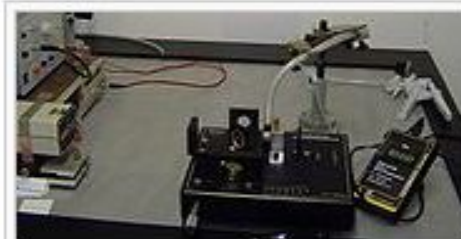
Современный интерферометр Майкельсона
