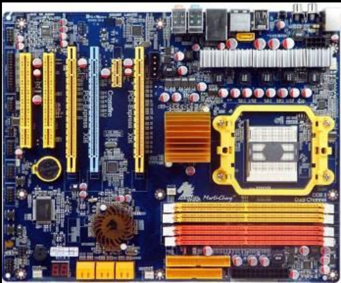
Полимерные конденсаторы с твёрдым электролитом на чипсете
