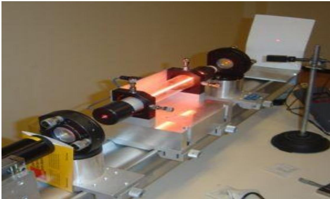
Основа лазера - **рубиновый** стержень . Торцы его строго параллельны друг другу. Работает в импульсном режиме на длине волны 694 нм (темно-вишневый свет), мощность излучения может достигать в импульсе 106–109 Вт.
