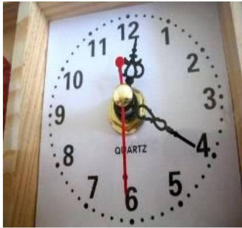
**Кварцевые часы — часы, в которых в качестве колебательной системы применяется кристалл кварца.**
