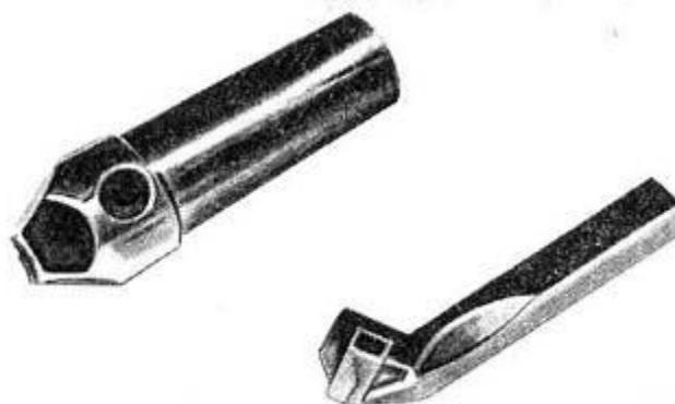
*Так выглядят алмазные резцы для обработки контактных линз.*
