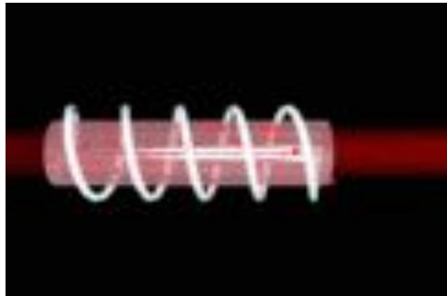
**Важнейшую роль в получении лазерного луча играет кристалл рубина ( $\text{Al}_2\text{O}_3$ ) с добавкой хрома.**
