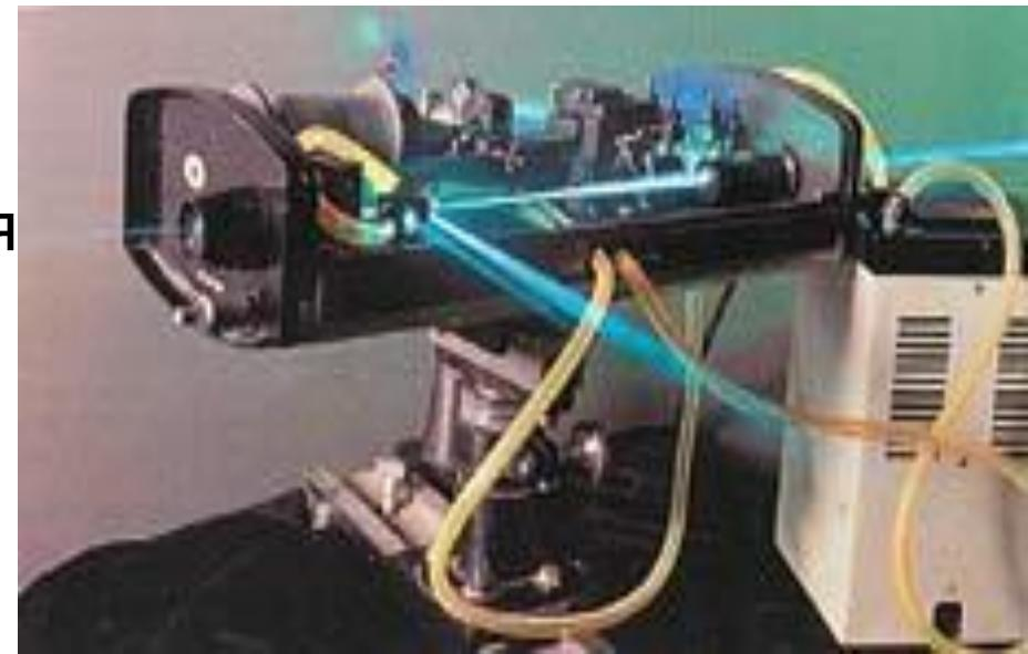
**Это небольшой лазер, однако он может прожечь материалы различного типа и на достаточно большом расстоянии .**
