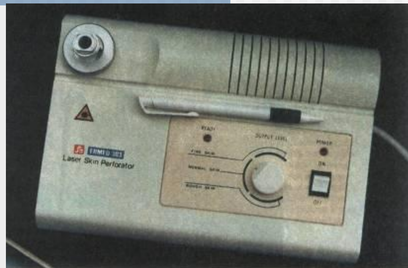
Лазерный перфоратор «Эрмед-303» для бесконтактного взятия проб крови.
