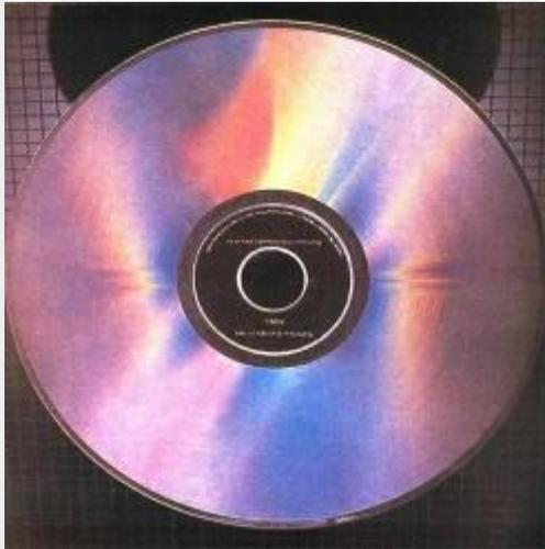
**Миниатюрные метки, сделанные на диске лазерным лучом, обеспечивают невиданную плотность записи.**
