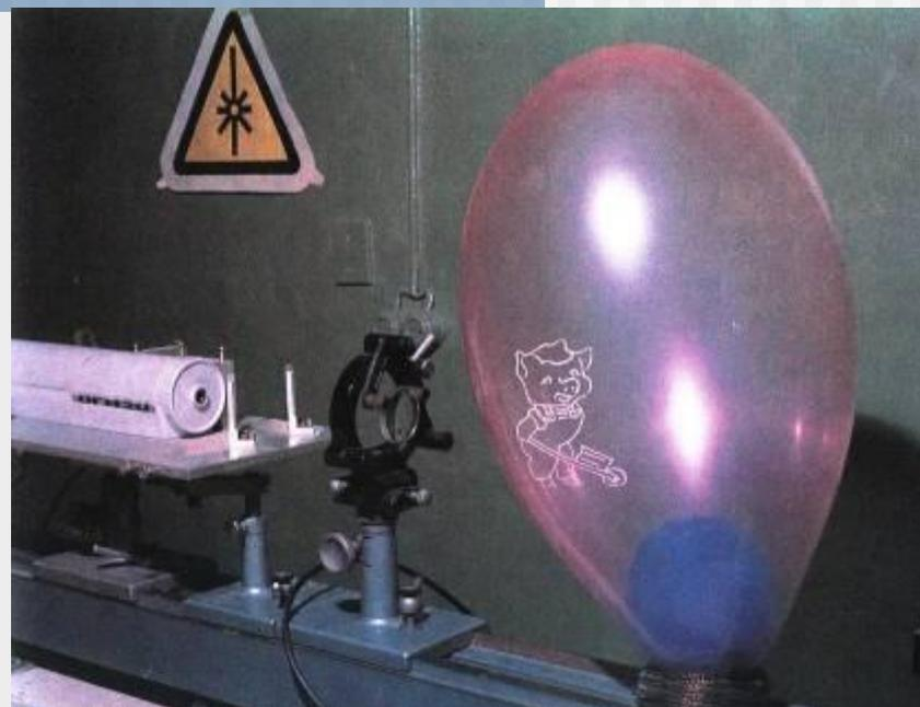
**Красный луч рубинового лазера свободно проходит сквозь оболочку красного шарика и поглощается синим, прожигая его. Поэтому при хирургической операции световой луч воздействует на стенку кровеносного сосуда, «не замечая» самой крови.**
