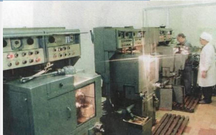
**Лазерные станки для шлифовки дорожки качения в кольцах сверхмалых подшипников.**
