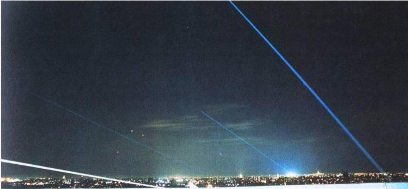
Лазеры на красителях позволяют следить за состоянием атмосферы. Современные города накрыты «колпаком» пыльного, закопченного воздуха. О степени его загрязнения можно судить по тому, насколько сильно в нем рассеиваются лазерные лучи с разной длиной волны. В чистом воздухе свет не рассеивается, его лучи становятся невидимыми.
