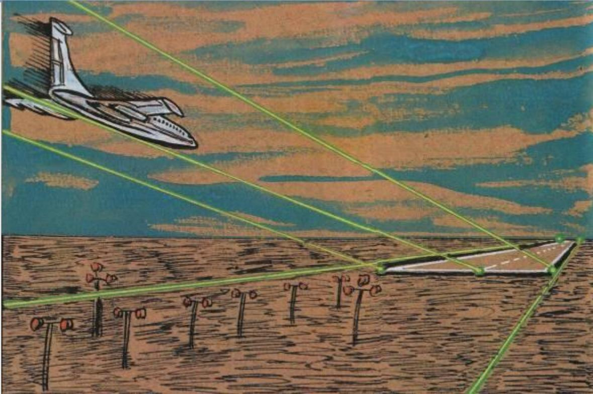
**Заходя на посадку, самолет движется по пологой траектории – глиссаде. Лазерное устройство, помогающее пилоту, особенно в непогоду, тоже названо «Глиссада». Его лучи позволяют точно сориентироваться в воздушном пространстве над аэродромом.**
