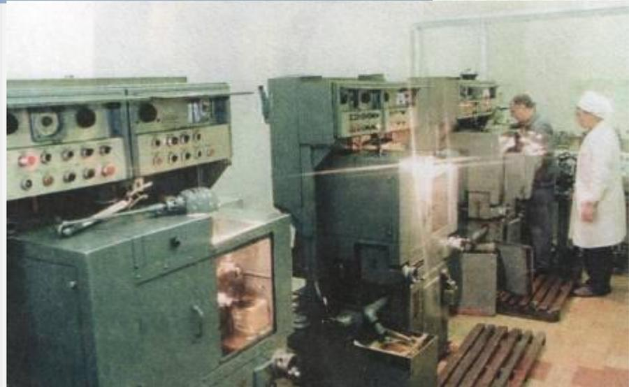
**Лазерные станки для шлифовки дорожки качения в кольцах сверхмалых подшипников.**
