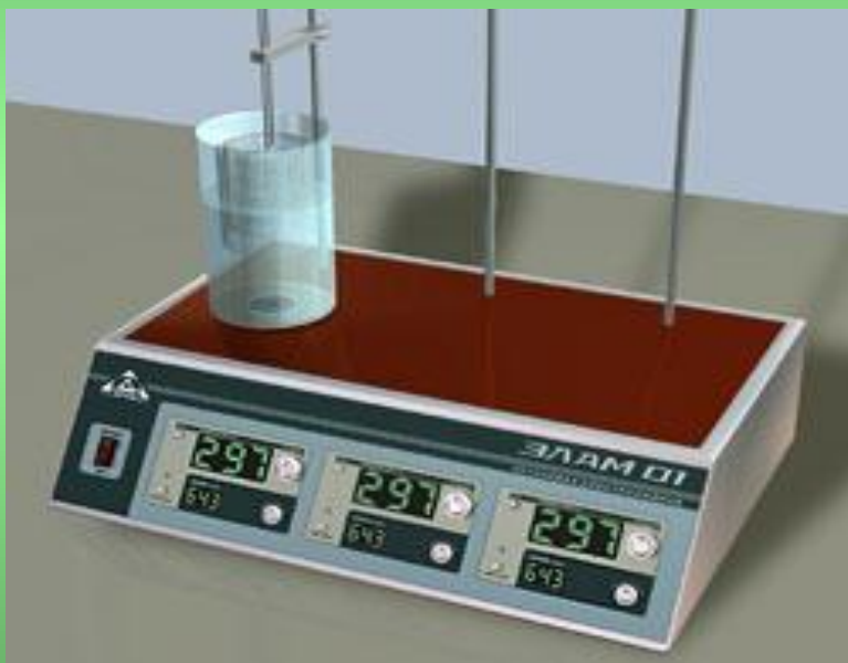
Лабораторная электролизная установка для анализа металлов «ЭЛАМ».
