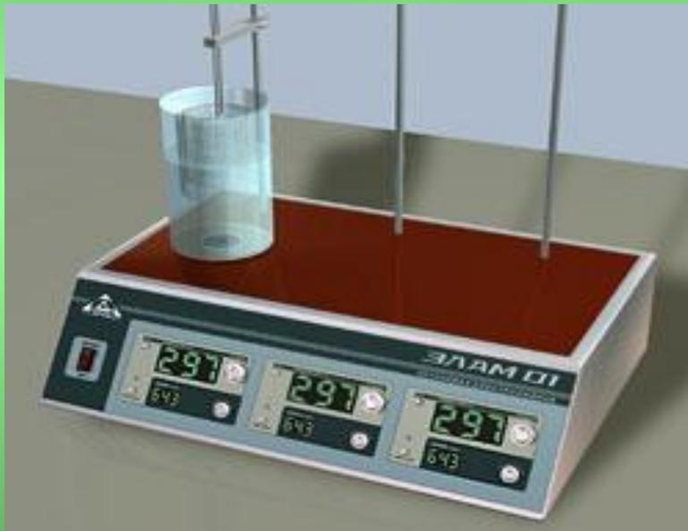
Лабораторная электролизная установка
