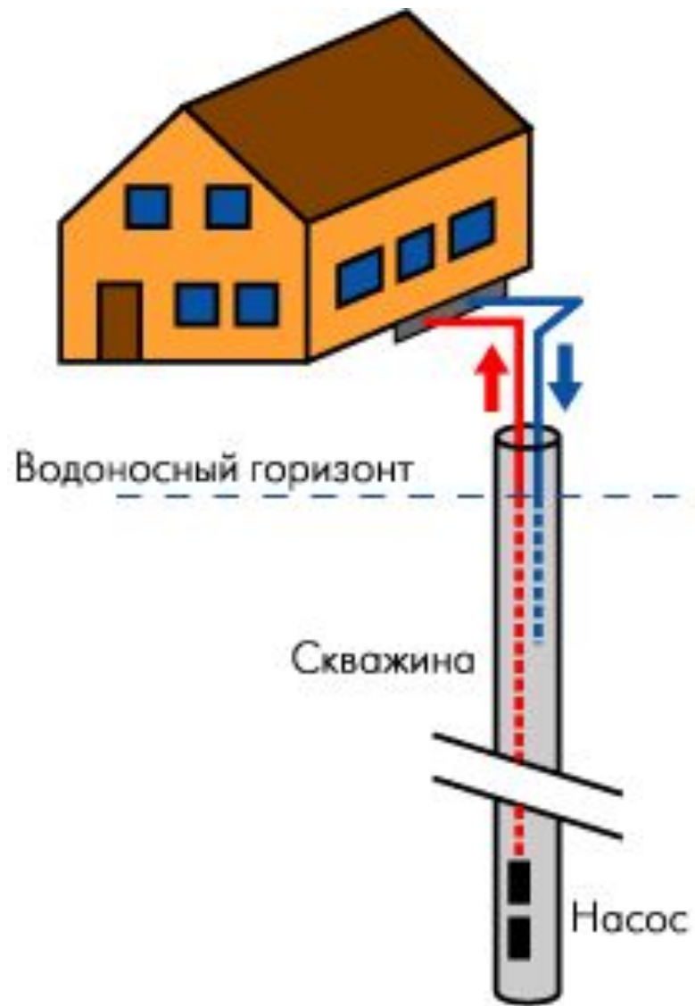
Схема скважины типа «колонна»
