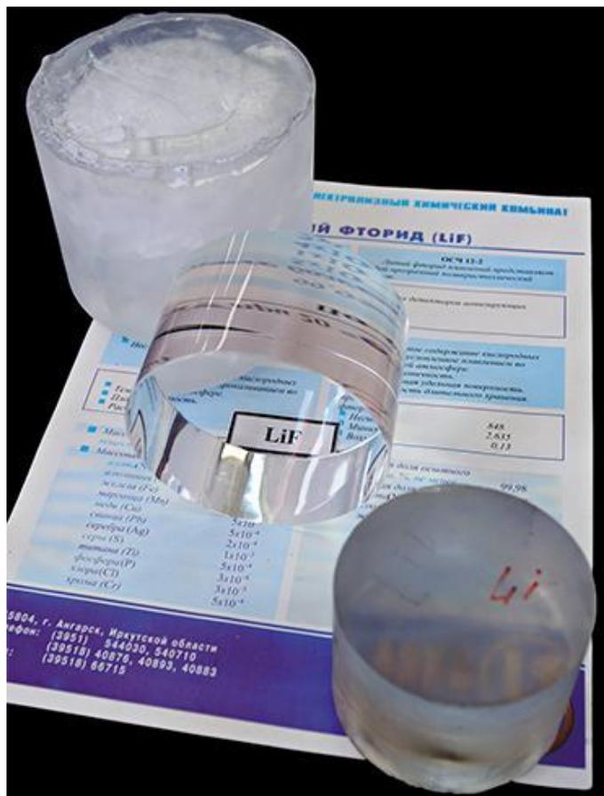
Рисунок 5 – LiF-дозиметр
