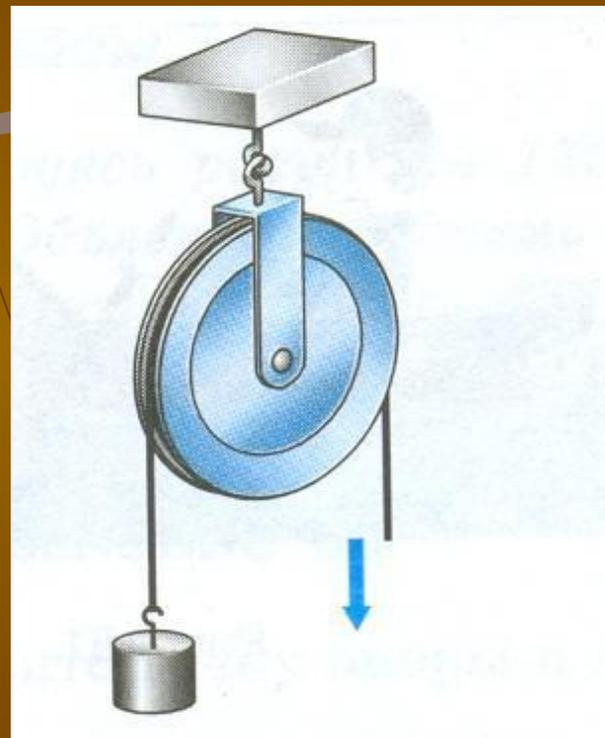
Неподвижный блок можно рассматривать как равноплечий рычаг, у которого плечи сил равны радиусу колеса:  $OA=OB=r$ . Такой блок не дает выигрыша в силе ( $F_1=F_2$ ), но позволяет менять направление действия силы.
