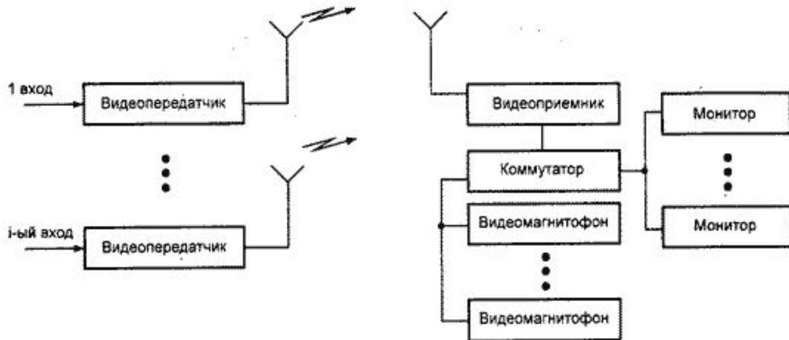
Рис. 1.35. Обобщенная схема беспроводной линии передачи-приема видеoinформации.
