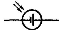
Рис. 3-7. Схематическое обозначение фотовольтаической ячейки (солнечного элемента).
