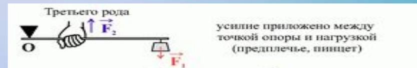
Различные простые механизмы, которые нас окружают, позволяют получить выигрыш в силе или расстоянии, делают нашу жизнь удобнее.
