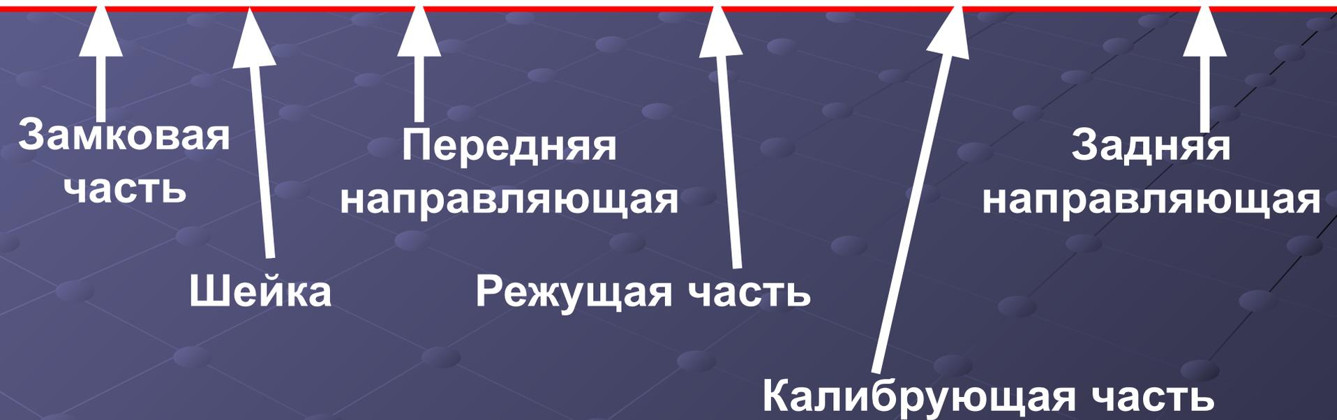
В теле протяжки действуют напряжения растяжения
