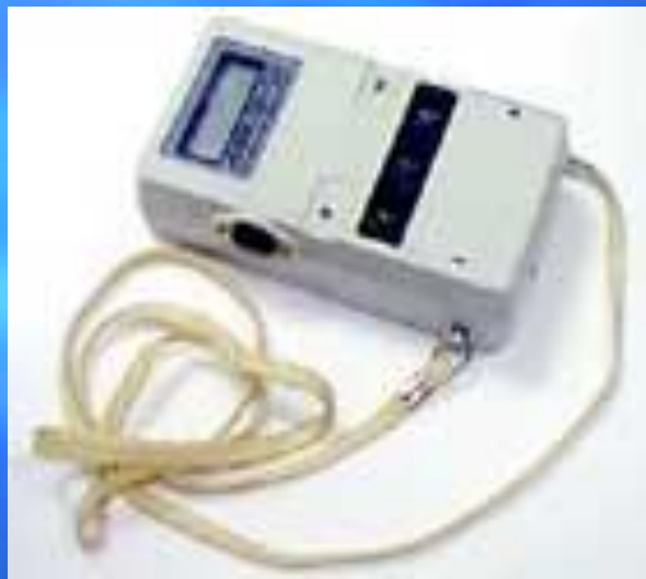
дозиметр-радиометр гамма- и бета-излучения АНРИ-01-02 "Сосна".
