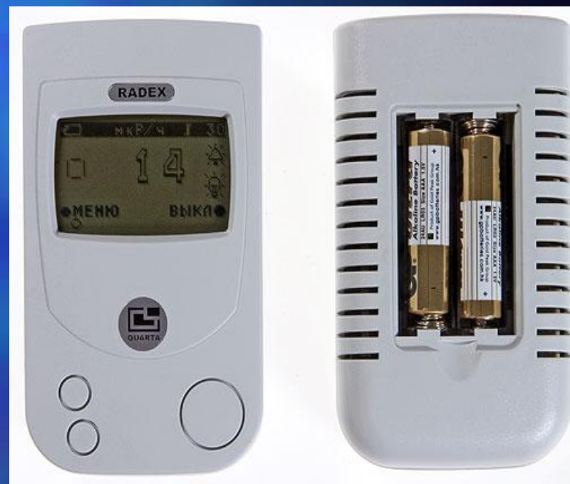
Дозиметр Радэкс РД 1706.
