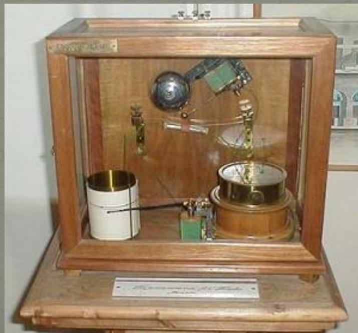
Принимаемая когерером электромагнитная волна создает высокочастотный переменный ток, который приводит к понижению сопротивления прибора в результате «спекания» опилок.
