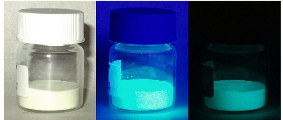
Фосфоресцентный порошок при облучении видимым светом, ультрафиолетовым светом и в полной темноте.
