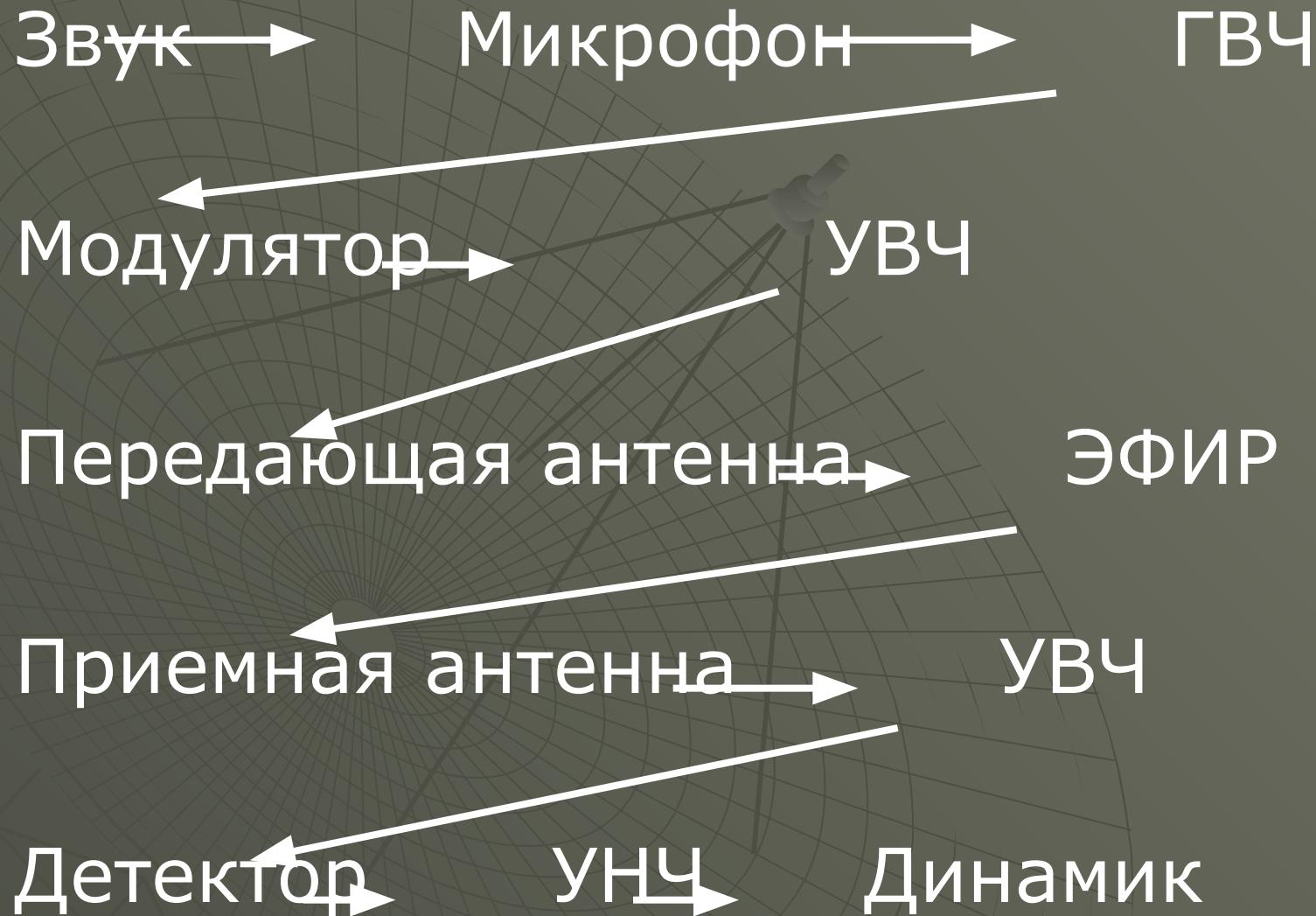
**Задающий генератор** вырабатывает гармонические колебания высокой частоты (несущая частота более 100 тыс. Гц).
