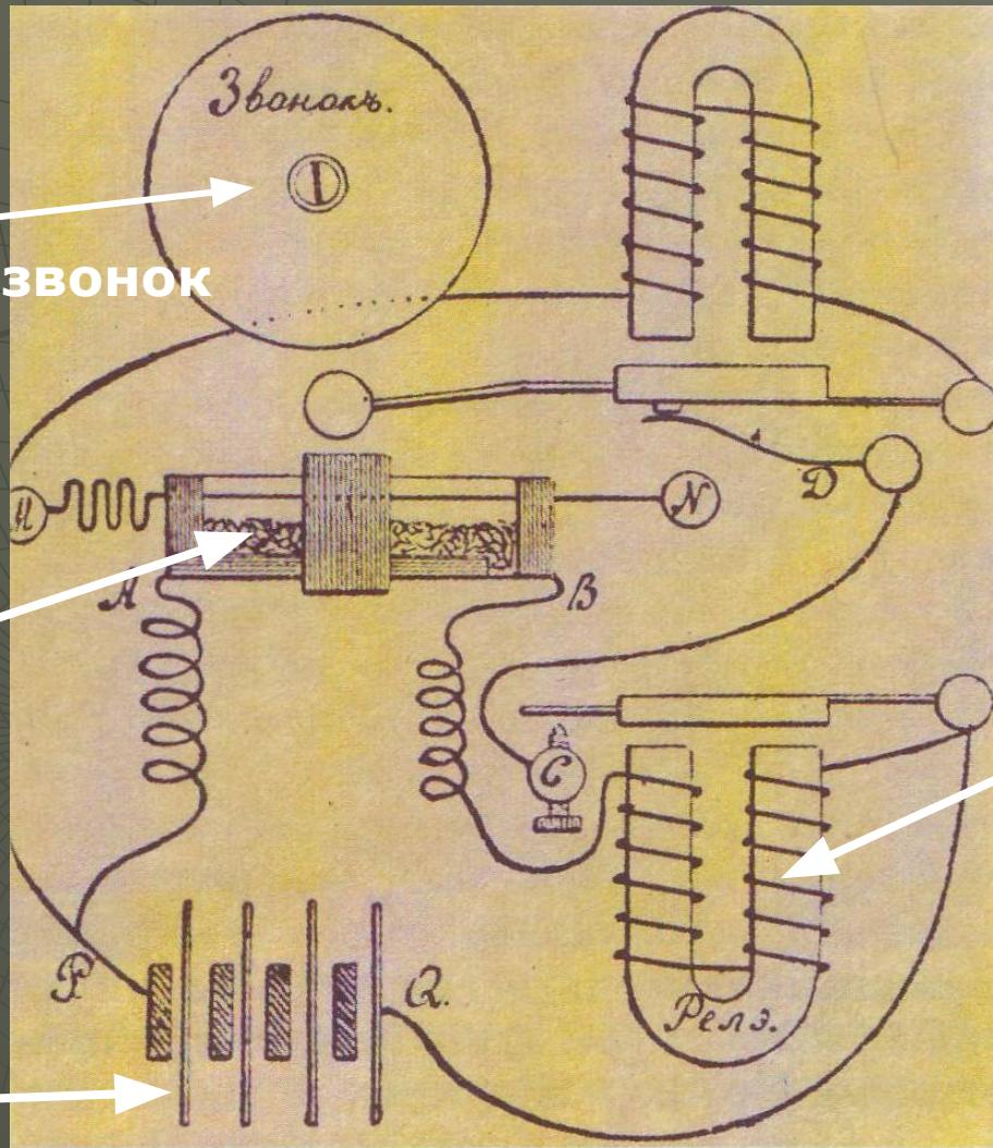
В антенне под действием переменного электрического поля возникали вынужденные колебания свободных электронов с частотой, равной частоте э/м волны. Переменное напряжение с антенны поступало на **когерер** – стеклянную трубку, заполненную металлическими опилками. Под действием переменного напряжения высокой частоты в когерере возникают электрические разряды между отдельными опилками, и его сопротивление уменьшается в 100-200 раз.
