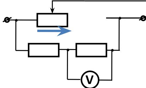
Будет ли изменяться и как показание вольтметра, если ползунок реостата перемещать в направлении, указанном стрелкой? Напряжение на зажимах цепи поддерживается постоянным.
