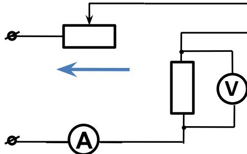
Изменяются ли показания амперметра и вольтметра, если ползунок реостата передвинуть в направлении стрелки?
