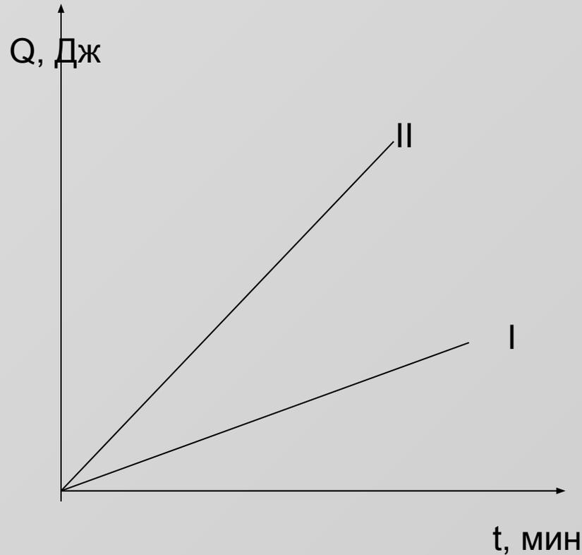
В алюминиевом чайнике нагрели воду. Построили графики зависимости количества теплоты от времени нагревания. Какой график построен для воды, какой – для алюминиевого чайника?
