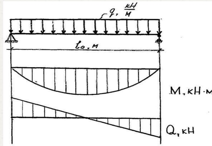
рис. 1 Расчетная схема
