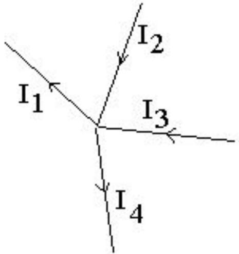
Алгебраическая сумма токов в узле электрической цепи равна нулю:
