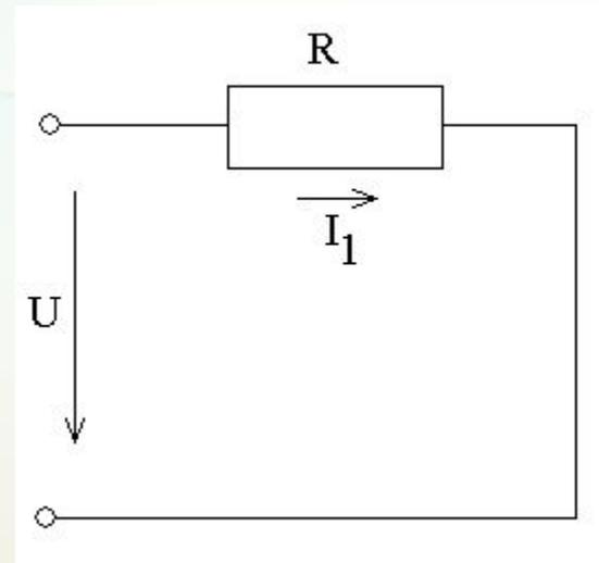
Определяем ток  $I_1 = U/R = 210/3 = 70 \text{ А}$
