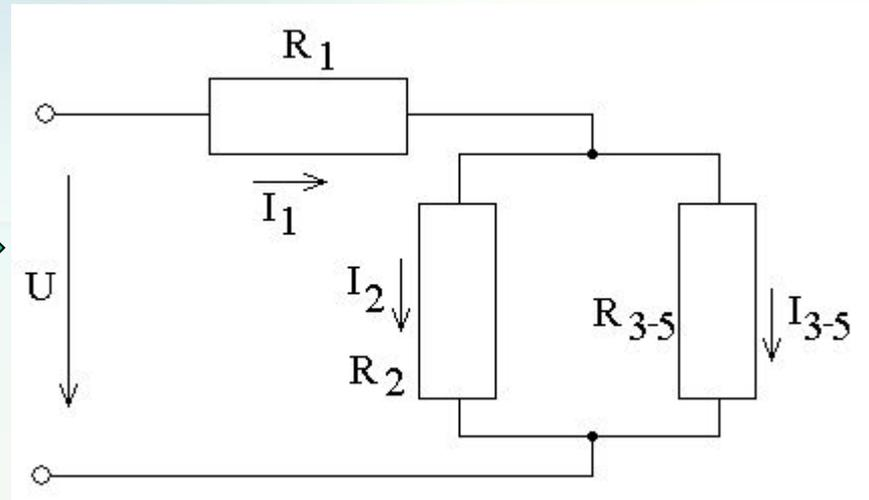
При параллельном соединении приемников на участках 2 и 3-5 напряжения равны:
