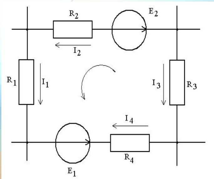
Алгебраическая сумма падений напряжений в ветвях любого замкнутого контура равна алгебраической сумме ЭДС, действующих в этом контуре,:
