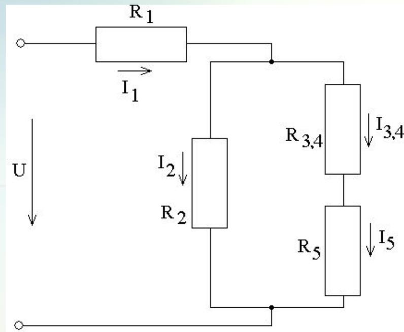
При последовательном соединении приемников в цепи проходит один и тот же ток,
