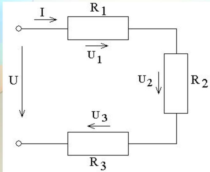
Напряжение на зажимах цепи  $U$  равно сумме напряжений на отдельных участках:
