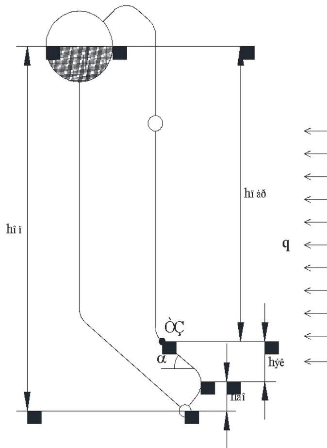
Для определения полезного напора контура необходимо знать точное место положения начала парообразования (точку закипания)
