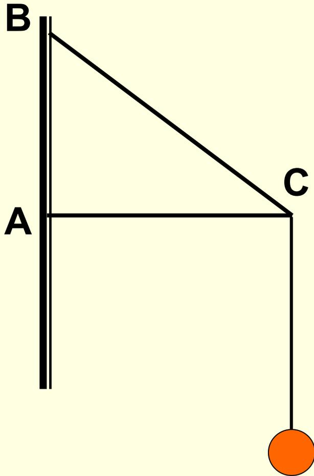
К концу двухметрового стержня AC, укрепленного шарнирно одним концом к стене, а с другого конца поддерживаемого тросом BC длиной 2,5 м, подвешен груз массой 120 кг. Найти силы, действующие на трос и стержень.
