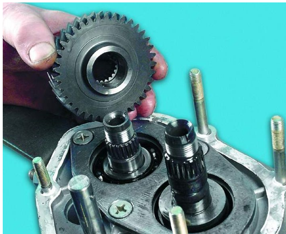
13. Снимите ведущую шестерню 5-й передачи с первичного вала. Обратите внимание, как она установлена.
