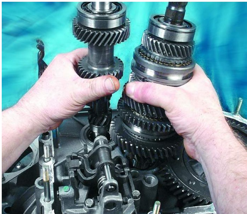
28. Слегка покачивая, выньте одновременно первичный и вторичный валы.
