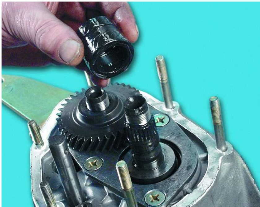
12. Снимите втулку с вторичного вала.
