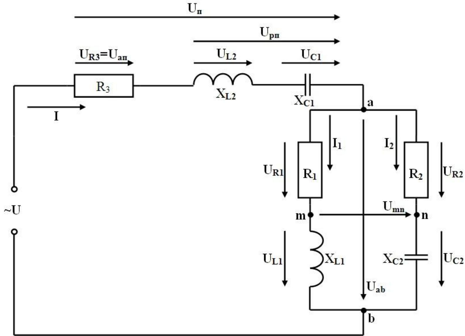
Где  $U_{R3}=U_{ap}$  – напряжение на  $R_3$ , что соответствует напряжению активной части последовательного участка цепи;
