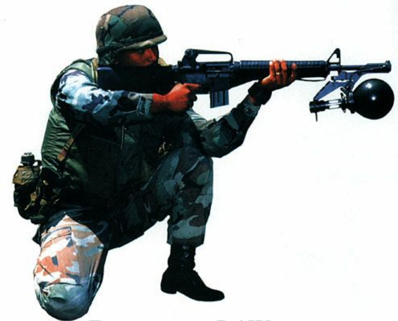
Реактивная граната «Брунswick» RAW представляет собой реактивный снаряд, запускаемый со ствола винтовки, который выглядит как сфера диаметром 140 мм. Заряд содержит 1,36 кг взрывчатого вещества. Снаряд способен проделать отверстие диаметром 360 мм в двойном армированном железобетоне толщиной 200 мм, а также поразить легкобронированные и небронированные цели на поле боя.
