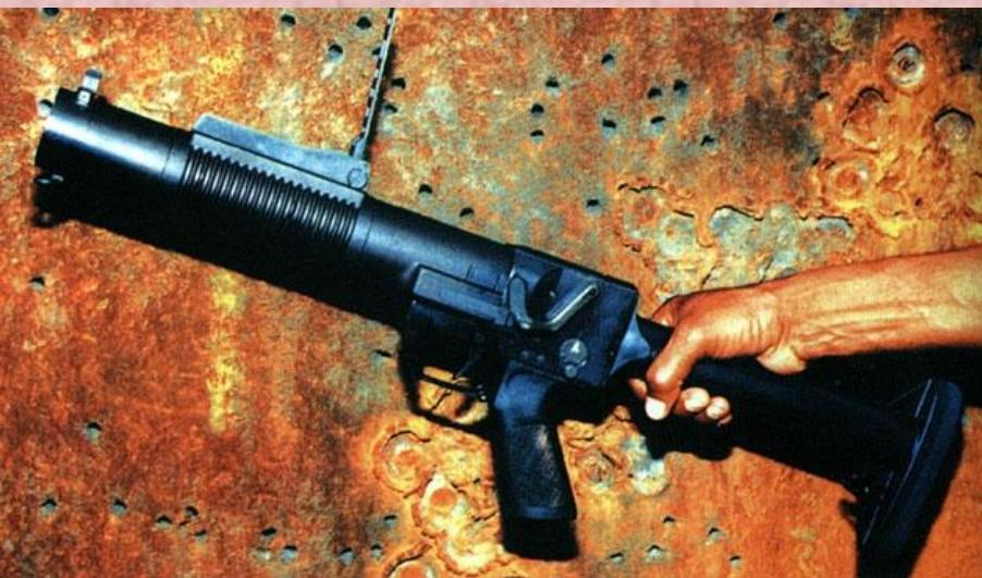
Однозарядный гранатомет-пистолет CIS-40G предназначен для огневой поддержки мелких пехотных подразделений. Он состоит на вооружении армии Сингапура. Максимальная дальность стрельбы 400 м.
