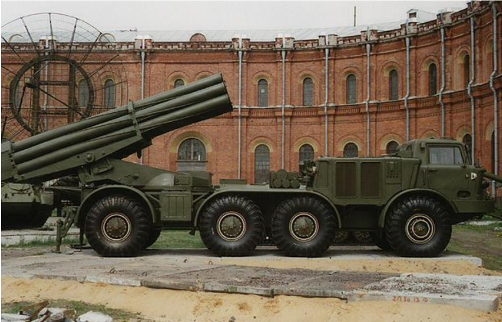
Реактивная система залпового огня «Ураган» была принята на вооружение советской армией в 1976 году. В качестве базы для боевой и транспортно-заряжающей машины использованы шасси ЗИЛ-135ЛМ. Боевая машина имеет 16 направляющих трубчатого типа. Количество возимых снарядов на транспортно-заряжающей машине – 16 штук.
