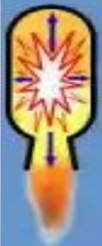
ПРИНЦИП РЕАКТИВНОГО ДВИГАТЕЛЯ
