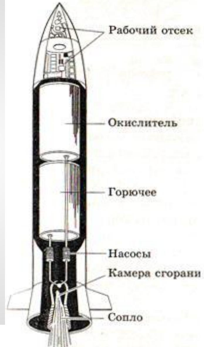
При горении топлива образуются газы, имеющие очень высокую температуру и оказывающие давление на стенки камеры. Сила давления на переднюю стенку камеры больше, чем на заднюю, где расположено сопло.
