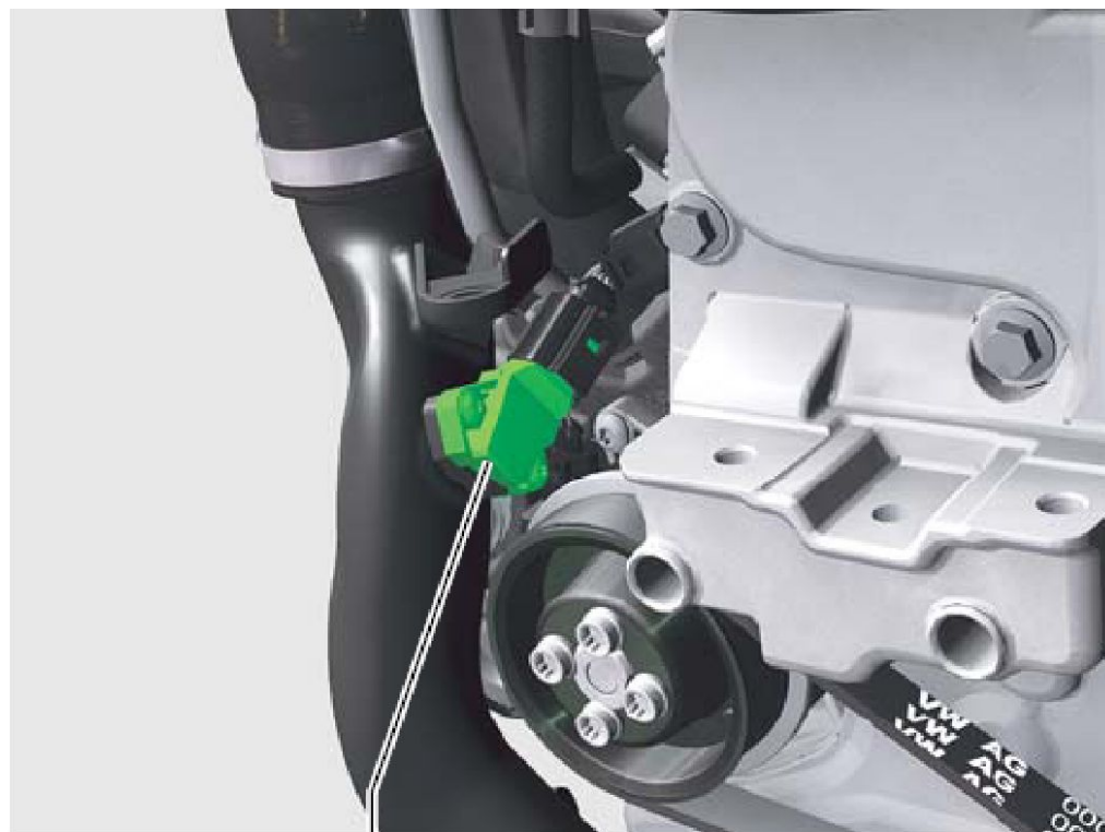
Датчик давления наддува G31 с датчиком температуры всасываемого воздуха G299
