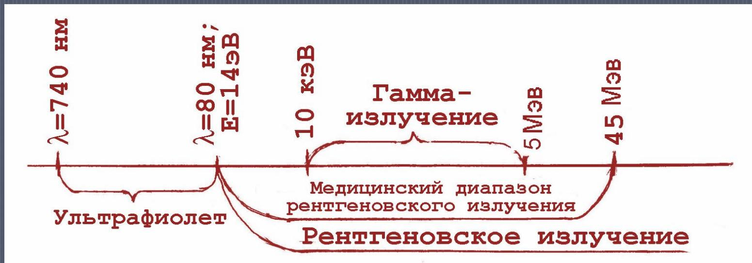
Энергетические диапазоны рентгеновского излучения и гамма-излучения перекрываются в широкой области энергий. Оба типа излучения являются электромагнитным излучением и при одинаковой энергии фотонов — эквивалентны. Терминологическое различие лежит в способе возникновения — **рентгеновские лучи испускаются при участии электронов** в то время как гамма-излучение испускается в процессах девозбуждения атомных ядер
