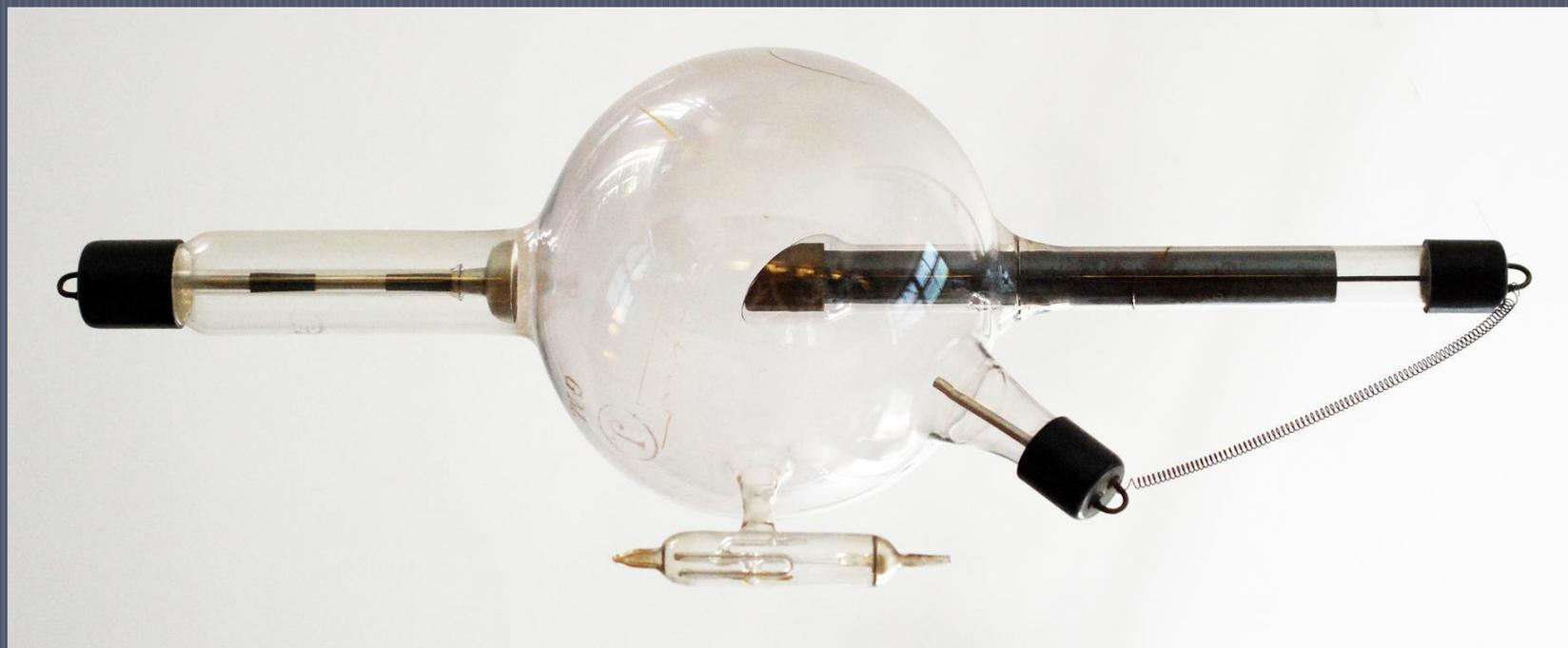
*Рентгеновские лучи возникают при сильном ускорении заряженных частиц*, либо при высокоэнергетических переходах в электронных оболочках атомов или молекул. Оба эффекта используются в рентгеновских трубках
