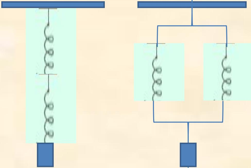
**Задача 1:** Как изменится период вертикальных колебаний груза, висящего на двух одинаковых пружинах, если их последовательное соединение заменить параллельным?
