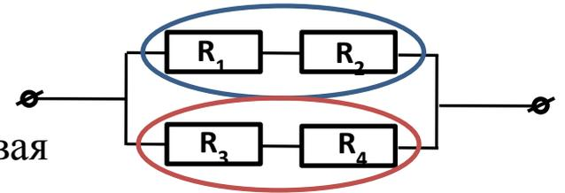
В данной цепи имеется два параллельных участка, каждый из которых состоит из двух последовательно соединенных резисторов.
